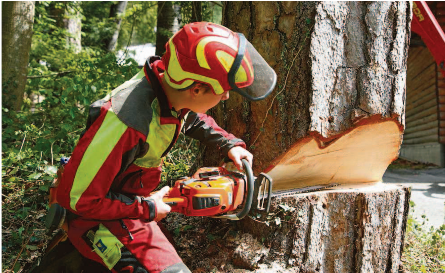
Forstwart-Lehrling Florian Ritter erklärt die wichtige Funktion einer Fallkerbe bei der Fällung eines Baumes.
